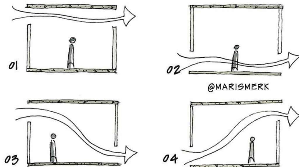
Ventilação cruzada em todos os ambientes para reduzir a necessidade de eletros climatizadores. Principalmente no ginásio poliesportivo, onde além da ventilação deste tipo contaremos com telha isotérmica.
